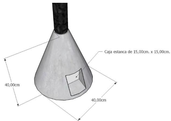
Base cónica de hormigón
