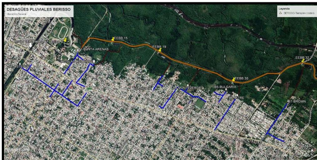
**Ilustración I-1: Imagen satelital traza del Terraplén de Defensa, Estaciones de Bombeo y trazas de conductos proyectados**
