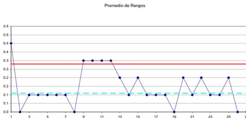
Gráfico 2. Promedio de Rangos (Valor Máximo – Valor Mínimo) para el Contenido de Asfalto Extraído de F10 de producción en Planta
